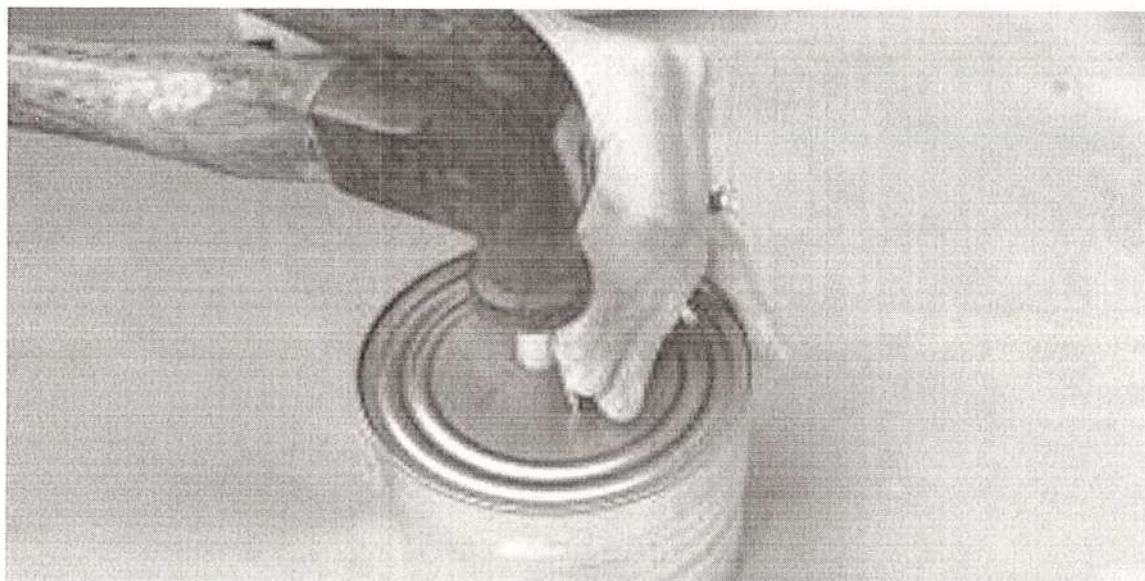
Рис. 4. Изготовление банки для забора донных отложений из водоема Мухля
